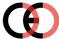
Falsk CE-mærke (for tæt på hinanden)
